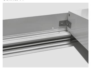
Sicherheitswinkel mit selbstschneidender Schraube durch den Aluwinkel verschrauben. Bei entsprechendem Montageuntergrund wie z. B. Beton, muss vorgebohrt werden.
