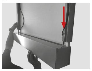
Seitenführungsschiene auf allen vier Seiten auf den Bolzen an der Kassette schieben.
